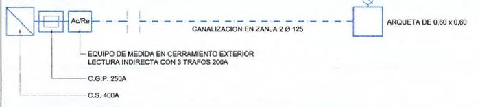
**NOTA :** SECCIONES DE CONDUCTORES Y TIPOS DE CABLES EN ESQUEMA GENERAL
