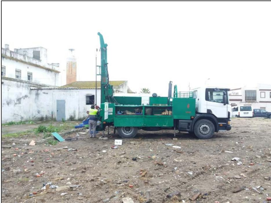
Durante la perforación de los sondeos se han realizado un total de 6 ensayos estándar de penetración SPT, cuyos valores, resultados de N30, nos permiten conocer la compacidad y homogeneidad de las capas prospectadas. La tabla siguiente muestra los valores N30 de los ensayos SPT realizados a diferentes profundidades durante la perforación del sondeo.
